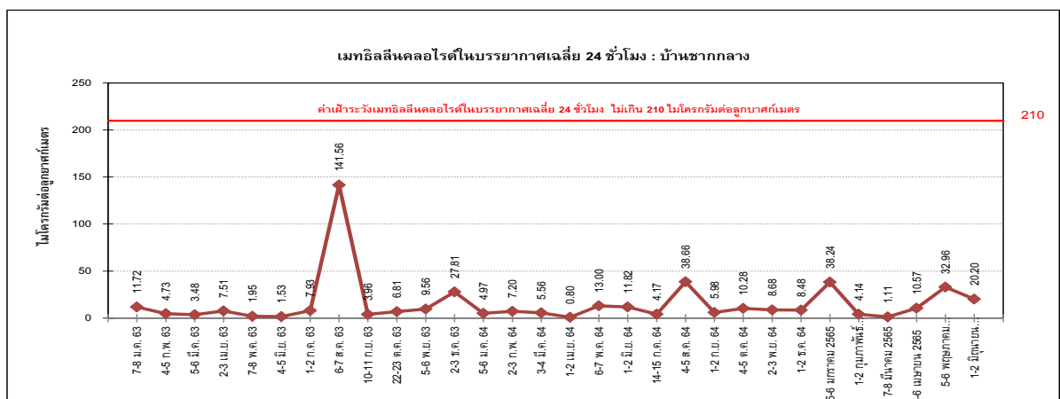
รูปที่ 3.4.1-8 แผนภูมิเปรียบเทียบผลการตรวจวัดก๊าซเมทิลลีนคลอไรด์ในบรรยากาศ โรงงานผลิตโพลีคาร์บอเนต บริษัท ไทยโพลีคาร์บอเนต จำกัด ระหว่างปี 2563-2565
